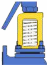
budowa otwarta kołpaka
